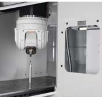
Bei den Portalfräsmaschinen D422 und D432 der C.B.Ferrari kann der 5-Achsen-Betrieb auch über einen mit Torquemotoren angetriebenen stufenlosen 2-Achsen Gabelfräskopf erzielt werden
