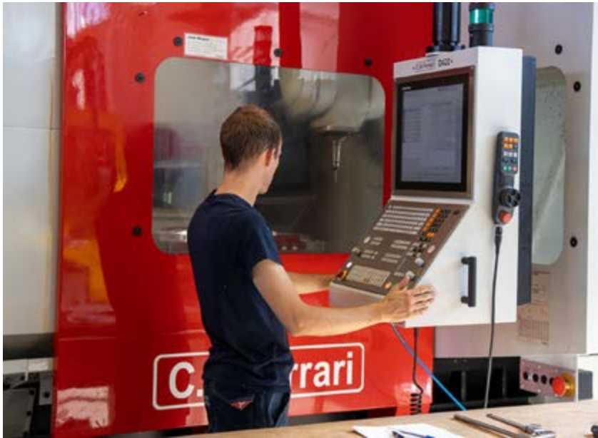
Die Bearbeitungszentren der D-Serie von der C.B.Ferrari sind mit einer Heidenhain Steuerung TNC640 HSCI ausgestattet und erzielen dadurch hohe Bearbeitungsgeschwindigkeiten und Genauigkeiten auf 5 Achsen
