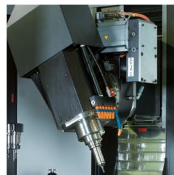
Apparecchio taratura utensili a contatto Tool setting device contact Kontakt Werkzeugeinstellgerät
