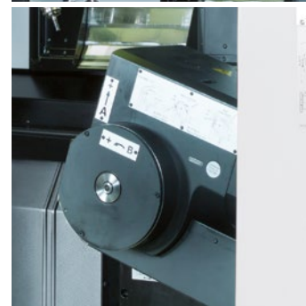
GRUPPO REFRIGERAZIONE VIA MANDRINO - 75 BAR - VASCA DA 460 LITRI - FILTRO A TAMBURO THROUGH SPINDLE COOLANT GROUP - 75 BAR - 460 LITERS TANK - DRUM FILTER SPINDEL-INNEKÜHLUNG - 75 BAR - 460 LITER WANNE - MEMBRAN-FILTER
