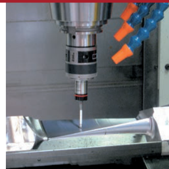
3D工件测量系统 3D touch probe
