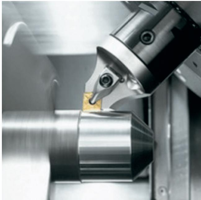
A236 设计初衷为多功能机床（多任务处理）：除了经典的铣削和钻孔操作外，它还提供车削功能，使您可以在同一台机床上完成一个工件的不同步骤，避免将其移动到其他机床，从而优化加工时间。车削功能需要工件以高速进行旋转，以便在保持刀具固定的同时去除材料。
