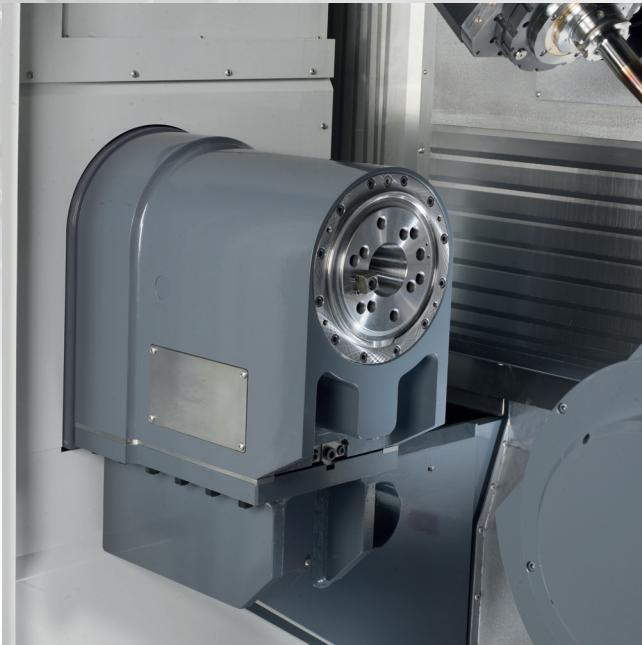
A236 在左侧配有一个固定的单轴分度头 (A2)，可以加装自动棒料装载系统。A2轴为工作轴；可联动 X、Y、Z 轴连续进行加工，与右侧两轴移动分度头A1 轴同步。
