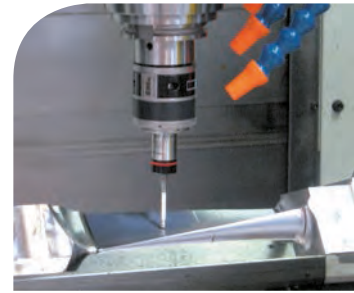
2D-3D 工件测量系统 2D-3D control piece group
