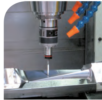
2D-3D 工件测量系统 2D-3D control piece group
