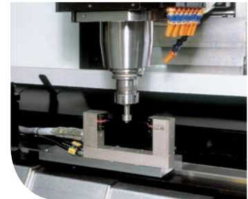
Taratura utensili laser Laser tools setting device
