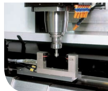
Taratura utensili laser Laser tools setting device
