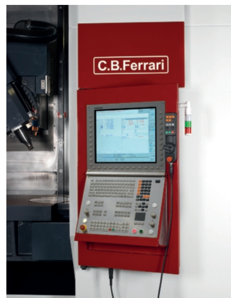
Pulsantiera ergonomica Cnc Heidenhain TNC 640.
