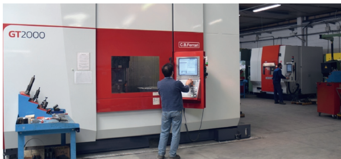
Il centro di lavoro verticale ad alta velocità C.B. Ferrari GT2000 è particolarmente indicato per soddisfare le esigenze produttive del settore degli stampi e delle lavorazioni che richiedono alti gradi di finitura superficiale.
