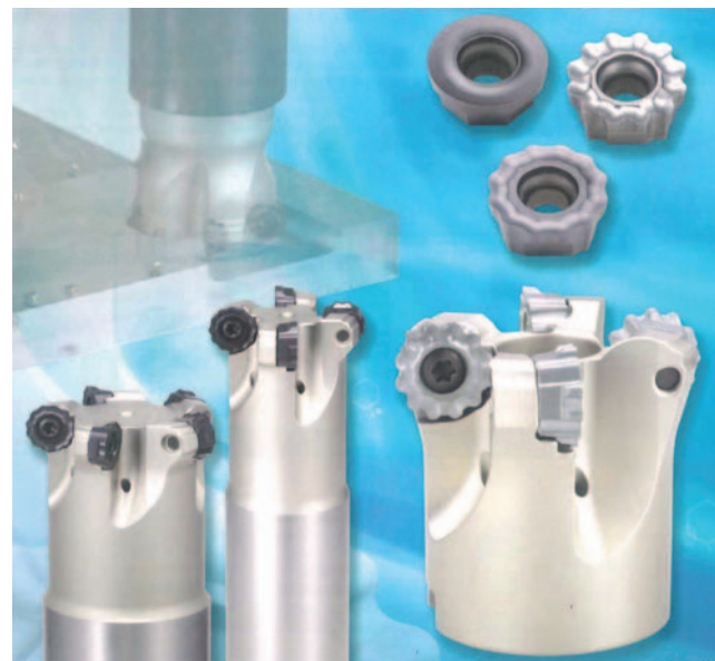
La fresa multifunzionale RoundSplit di Tungaloy, grazie all'inserto tondo con i taglienti dentellati, possiede la caratteristica di frantumare il truciolo, rendendo minime le forze di taglio e quindi le vibrazioni.
